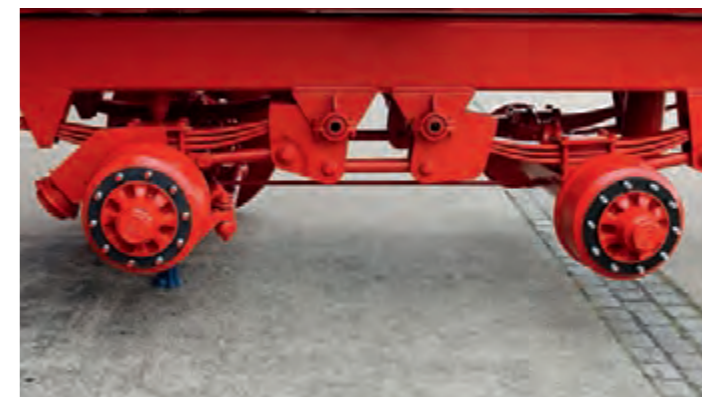
32-ух тонные параболические рессоры с продольными рычагами, и межосевым расстоянием 1,81 м.
