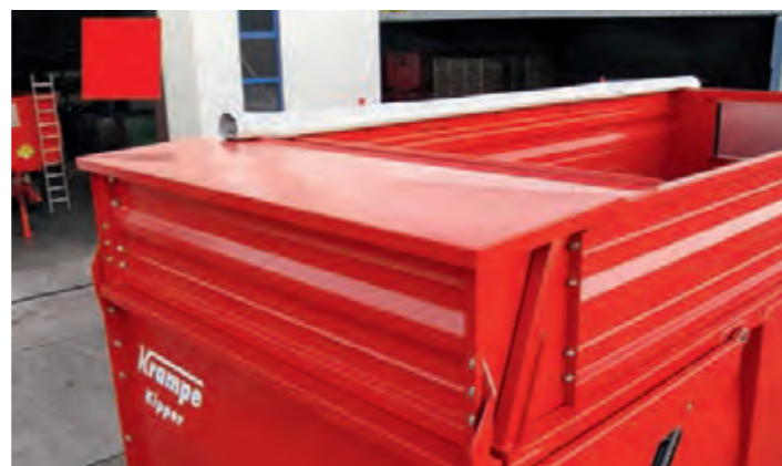
Продольный накрывной тент совместим с надставными бортами.
