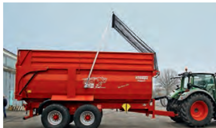
Сетчатый тент „Quick-Cover“ с электроприводом.
