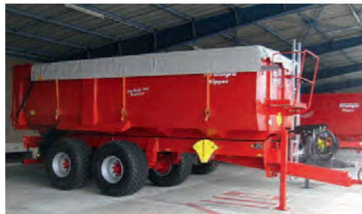
Продольный накрывной тент крепится прямо на бункере.
