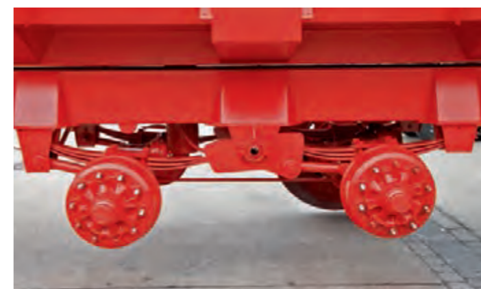
24-32-ух тонные параболические рессоры с продольными рычагами и межосевым расстоянием 1,36-1,55 м.
