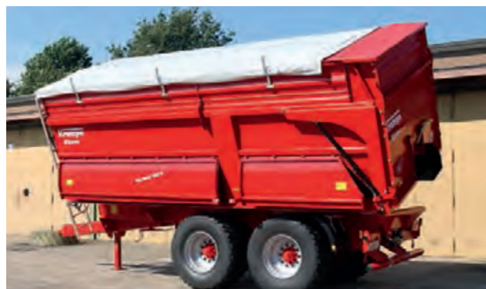
Продольный накрывной тент – простое и самое бюджетное решение.
