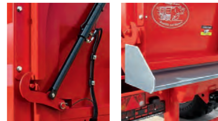
Автоматический запирающий крюк внизу с автоматическим запирающим клапаном в цилиндре.
