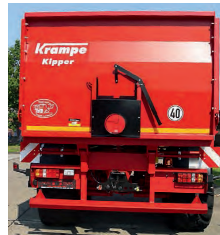
Вид сзади с автоматическим тягово-сцепным устройством, патрубками для подвода воздуха и масла, защитными решетками для задних и стояночных фонарей, круглый надставной желоб.
