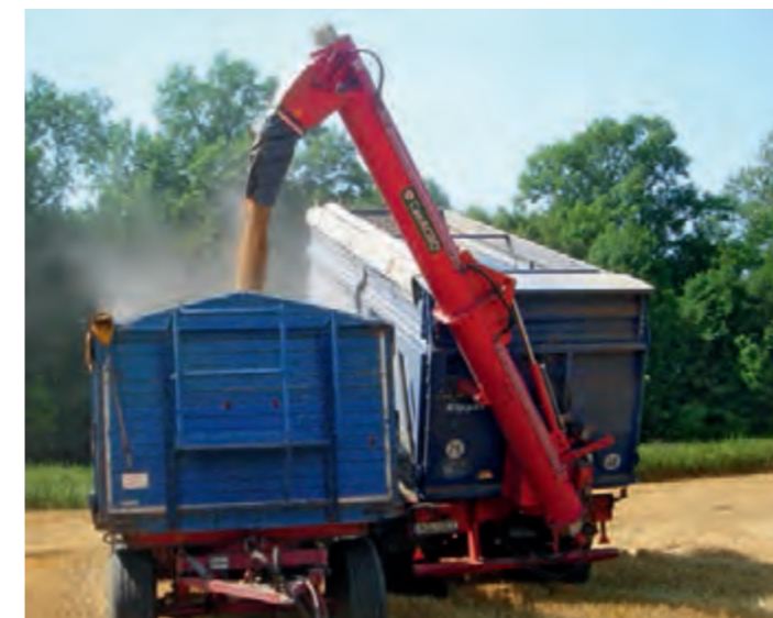
Перегрузочный шнек с боковой разгрузкой и производительностью от 20 до 180 т/ч.
