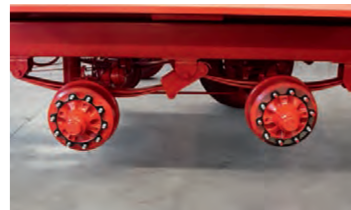
20-ти тонные параболические рессоры для Big Body 500/540. Обратите внимание на размер дорожного просвета.
