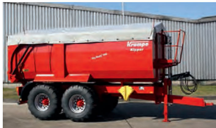
Тент с треугольным креплением – хорошо зарекомендовавшее себя решение для небольших бункеров.
